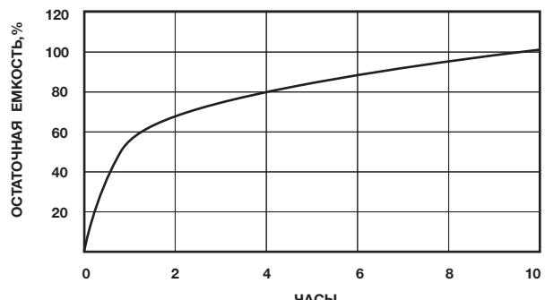
Рис. 2. Зависимость средней фактической ёмкости от времени разряда для батарей AGM FIAMM
