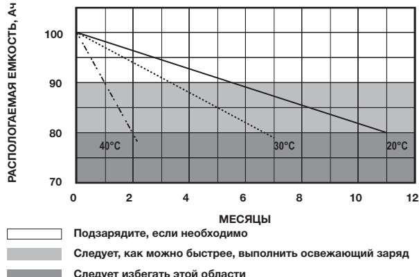
Рис. 8. Время хранения в зависимости от температуры воздуха
